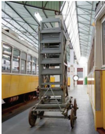
Fig. 7 - Escada Telescópica formada por segmentos deslizantes em sentido vertical de modo a permitir chegar a locais de difícil acesso, tais como a rede aérea, foi construída nas oficinas da Companhia Carris, cerca de 1917
