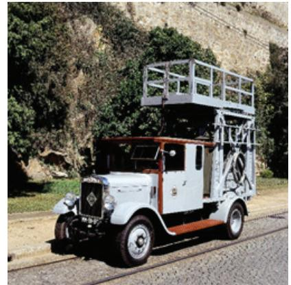
Fig. 6 - Veículo Hansa-Lloyd adquirido pela Companhia Carris de Ferro do Porto no ano de 1928. A solução da torre elevatória foi concebida propositadamente para operar na rede e solucionar o problema de circulação sem estarem dependentes do carril.
