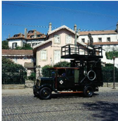
Fig. 5 - Veículo Hansa-Lloyd adquirido pela Companhia Carris de Ferro do Porto no ano de 1928. A solução da torre elevatória foi concebida propositadamente para operar na rede e solucionar o problema de circulação sem estarem dependentes do carril.
